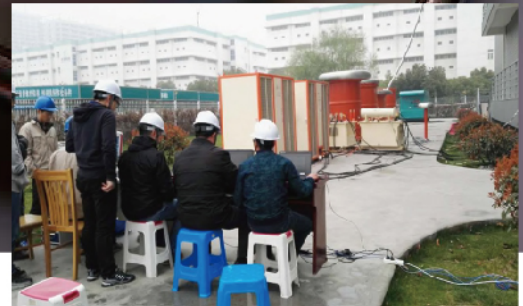
南京嘉庆变220kV工程竣工局放检测 Nanjing Jiaqing substation 220kV project
