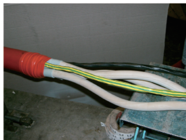
图2: 0.6/1kV条件下PROTOMONT(V)及(Z)的标准封头。
